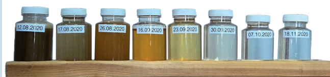
Fot. 5. Poprawa jakości wody uzdatnianej systemem VGT ATS
